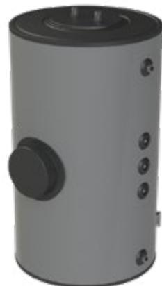
La gama de interacumuladores concept para instalaciones con Aerotermia, están fabricados con aleación 444 con un proceso de soldadura a testa y con un bajo input térmico, consiguiendo una optima penetración del cordón de soldadura, evitando la aparición de picaduras y corrosión por defecto en la propia soldadura.
